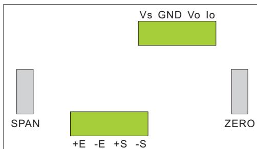
**24V DC** 电源输入以及从变送器到 **0~10V/4~20mA** 信号输出:
